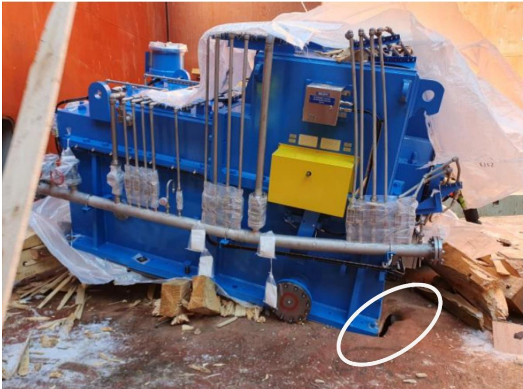
Рис. 10. Последствия падения груза в порту Усть-Луга [28]
